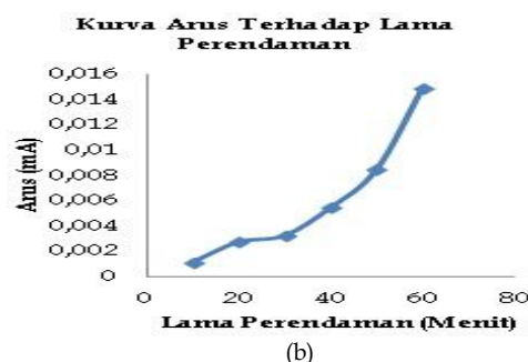
Gambar 4. Kurva (a) Tegangan dan (b) arus terhadap lama perendaman dalam larutan dye
