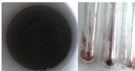
Gambar 4.5. : Hasil sintesis nanopartikel perak dengan metode hidrotermal tanpa *stabilizer*
