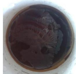
Gambar 4.7 : Sintesis nanopartikel dengan metode hidrotermal dengan penambahan *stabilizer* (PVA)
